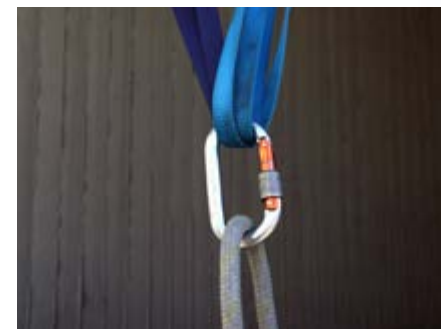
Dispositif de renvoi avec mousqueton à virole à vis
